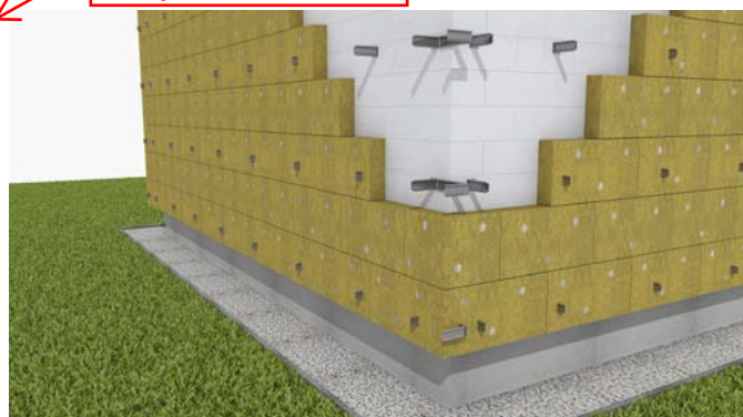
WIZ.121.2. Ułożenie i zakotkowanie wełny do ściany.
